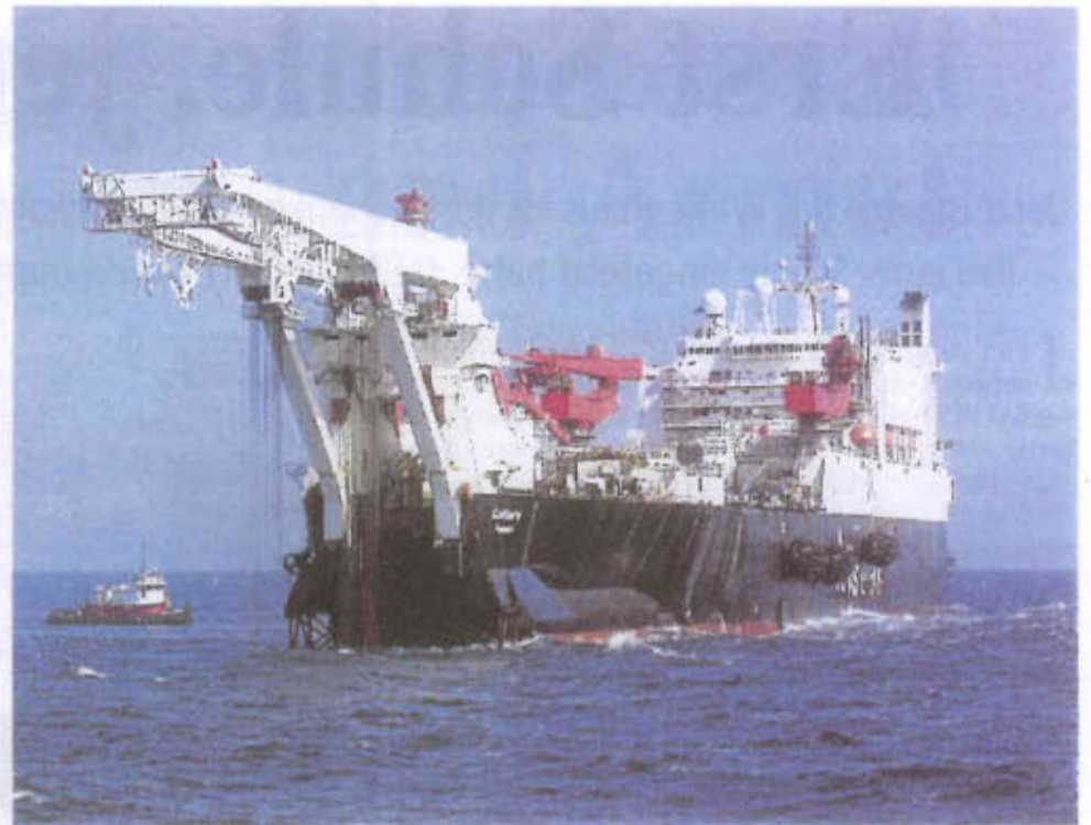
Auf der „Solitaire“, einem 300 Meter langen Schiff, das Tiefwasser-Pipelines verlegt, ... .. installieren die 15 Männer neue Schweißanlagen mitten auf dem Atlantik.
